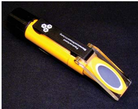
Handrefraktometer ZEISS Typ 92
