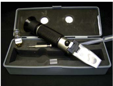
Handrefraktometer ARCARDA REF 116c (ATC) Fotos: LWK NRW Münster
