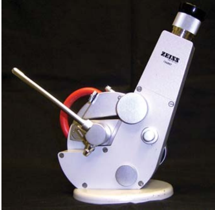
ZEISS Abbe Tisch-Refraktometer (Laborqualität)
