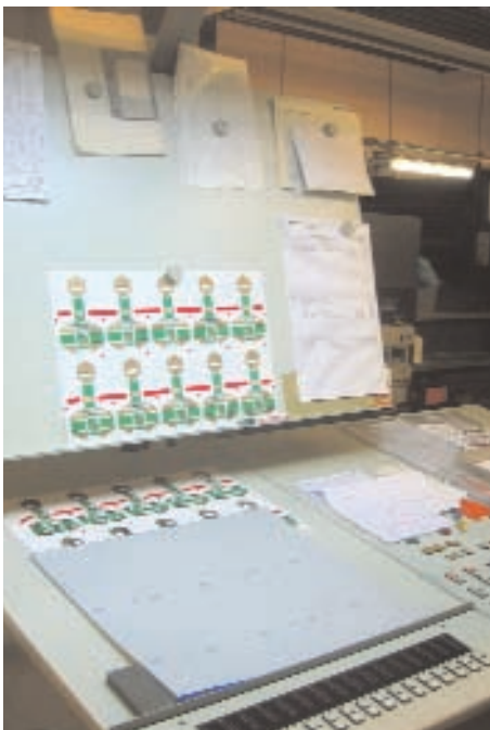
Bedienpult der Druckmaschine mit Stanzbogen als Farbprobe während der Produktion (Fotos: Karin Ditges)
